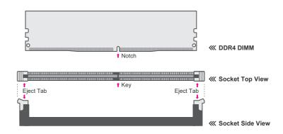
► Installing the DIMM Module
